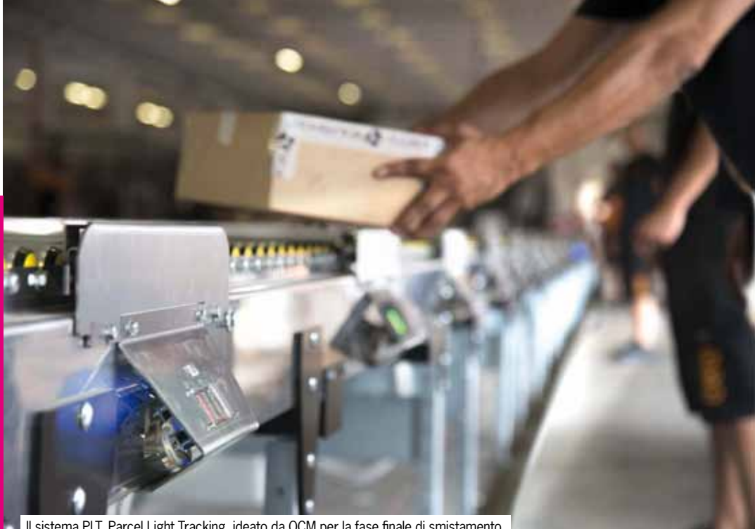
Il sistema PLT, Parcel Light Tracking, ideato da OCM per la fase finale di smistamento.
